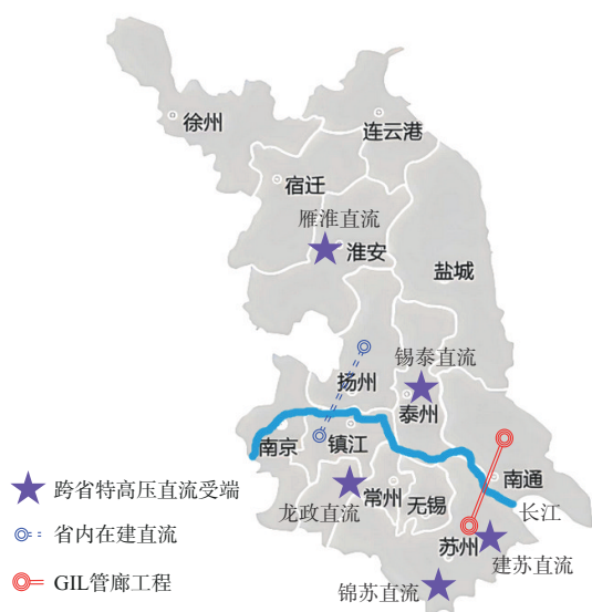
图 6 江苏省主要直流落点及过江通道 Fig. 6 DC terminals and river-crossing tunnels in Jiangsu Province of China
